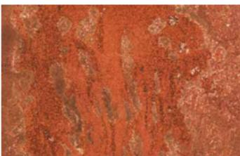
Entfernen Sie den losen Rost mit einer Drahtbürste oder einem anderen Schleifmittel. Restrost wandeln Sie am besten mit ADLER Ferrobloc um.
